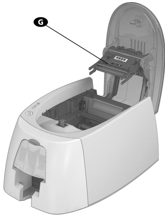
**G** Cabezal de impresión térmica
